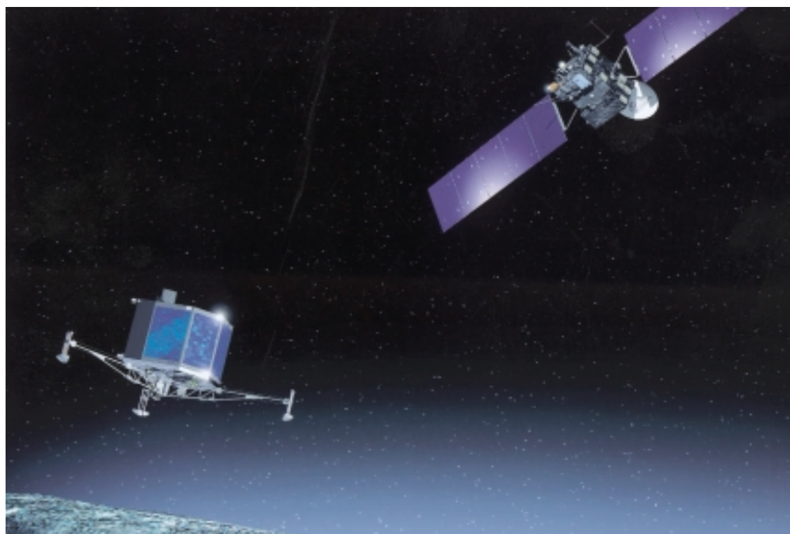
↓ La sonde Rosetta doit déposer un robot nain à trois pieds sur le noyau d'une comète. (ESA/J. Huart)
