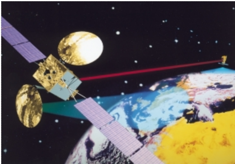
Grande "première" pour l'ESA et l'industrie européenne: une liaison optique, par faisceau laser, entre le satellite d'observation SPOT-4 et le satellite de télécommunications ARTEMIS. (ESA)
