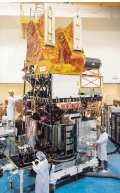
↑ La Belgique avec ses industriels participe au programme français SPOT d'observation de la Terre. La SONACA a réalisé en matériaux composites la structure porte-instruments de l'imposant SPOT-5, tandis que Alcatel ETCA a fourni le sous-système d'alimentation électrique de la plate-forme. (Photo Astrium)
