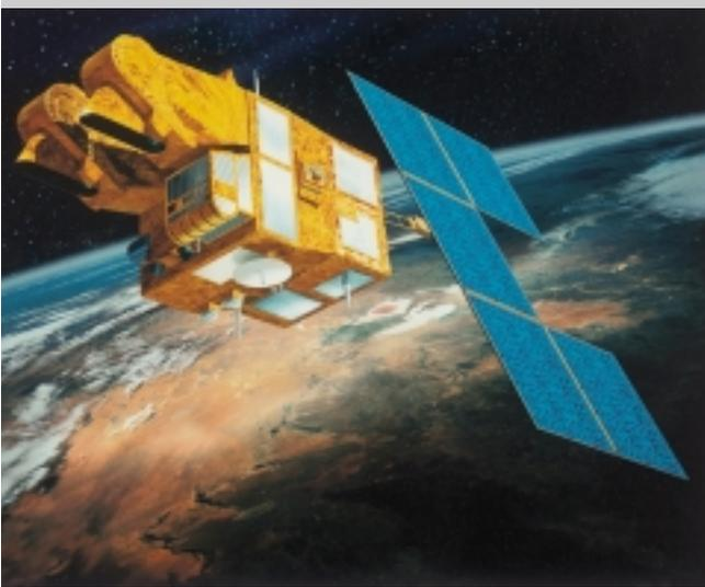
↑ Le satellite français de télédétection multispectrale SPOT-5, auquel la Belgique participe, est équipé de l'instrument Végétation pour l'observation du couvert végétal. En 48 heures, cet équipement photographie l'ensemble du globe dans les bandes bleue, rouge, infrarouge court et proche infrarouge. Ses images permettent l'étude des interactions des interactions entre la végétation, le climat, le cycle du carbone, les productions agricoles et forestières. (Dessin CNES/D.Ducros)
