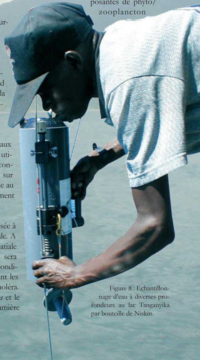
Figure 8 : Echantillonnage d'eau à diverses profondeurs au lac Tanganyika par bouteille de Niskin.
