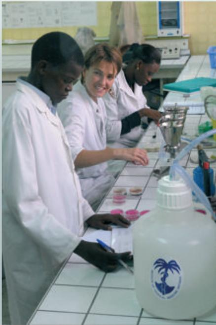
Figure 6 : Analyses des eaux par filtration de membrane au sein de l'INRB.
