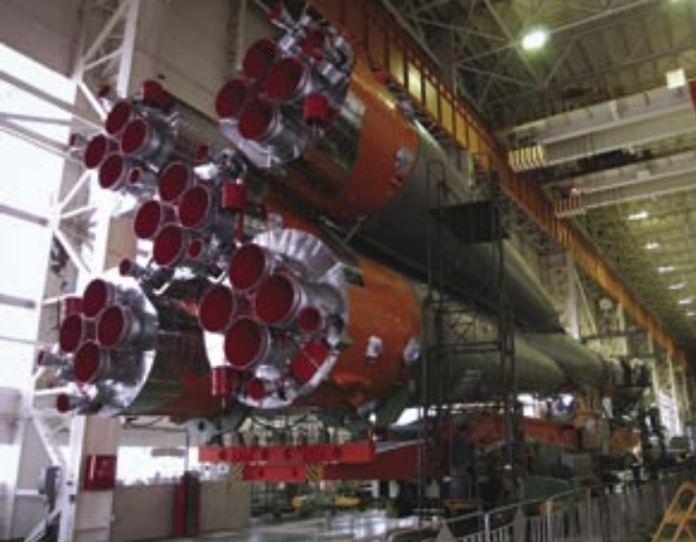
De Semjorka-raket, waarvan de Sojoez de krachtigste versie is, maakt indruk door haar twintig stuwmotoren van de eerste trap. (NASA)
