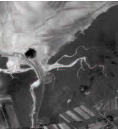
De camera's met hoge resolutie CHRIS en HRC aan boord van PROBA kunnen details van respectievelijk 18 meter en 5 meter onderscheiden. Dit is een CHRIS-opname van de omgeving van de Mont Saint-Michel.
