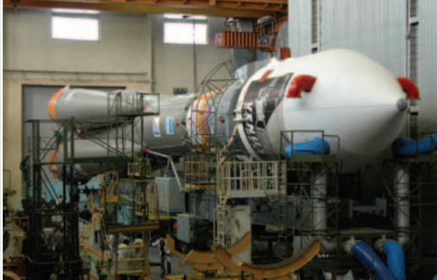
De Sojoez-Fregatlanceerraket van Venus Express wordt in de MIK 40-montagehal op Bajkonoer klaargemaakt voor de lancering. © ESA
