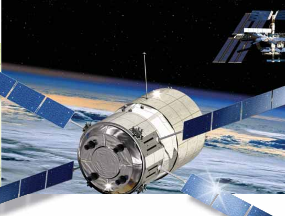
Un ATV en route vers l'ISS. Les quatre grands panneaux solaires et les quatre moteurs principaux du vaisseau spatial ne passent pas inaperçus. © ESA
