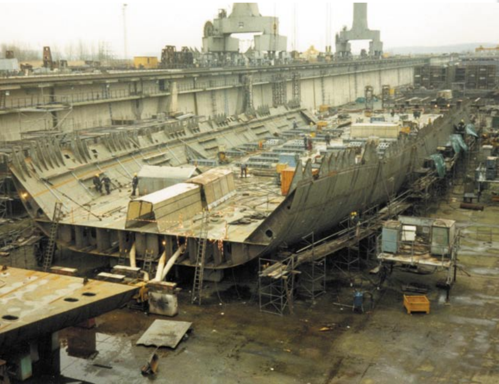
La construction du transporteur de GPL Nyhall en janvier 1989 (©Archives de l'État à Beveren)
