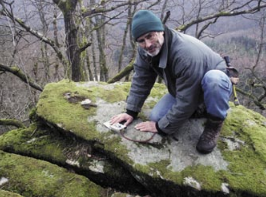
Mesure de la stratification des couches à l'aide d'une boussole de géologue
