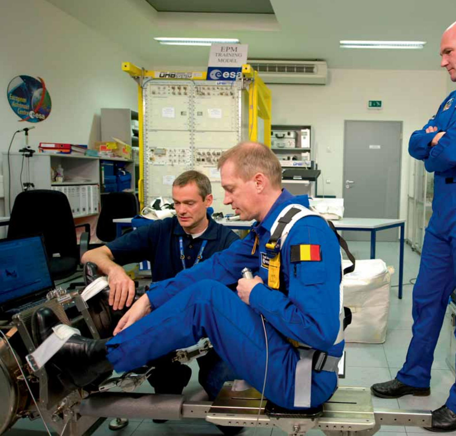
Frank De Winne en zijn Nederlandse reserve André Kuipers in het European Astronaut Centre (EAC) in Keulen, Duitsland. Ze oefenen met het Flywheel Exercise Device, bedoeld voor onderzoek van de menselijke fysiologie. (ESA)
