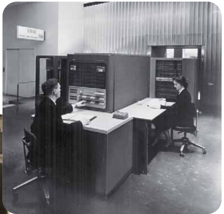
Le modèle IBM 704 Data Processing System, lancé en 1954, était un ordinateur à taille humaine conçu à des fins d'ingénierie et de calculs scientifiques. IBM vendit plus de 100 modèles de ce système avant les années 1960. © IBM
