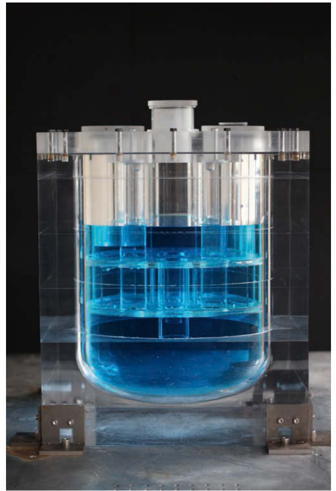
Figuur 4 – model op schaal 1/25 van MYRRHA
