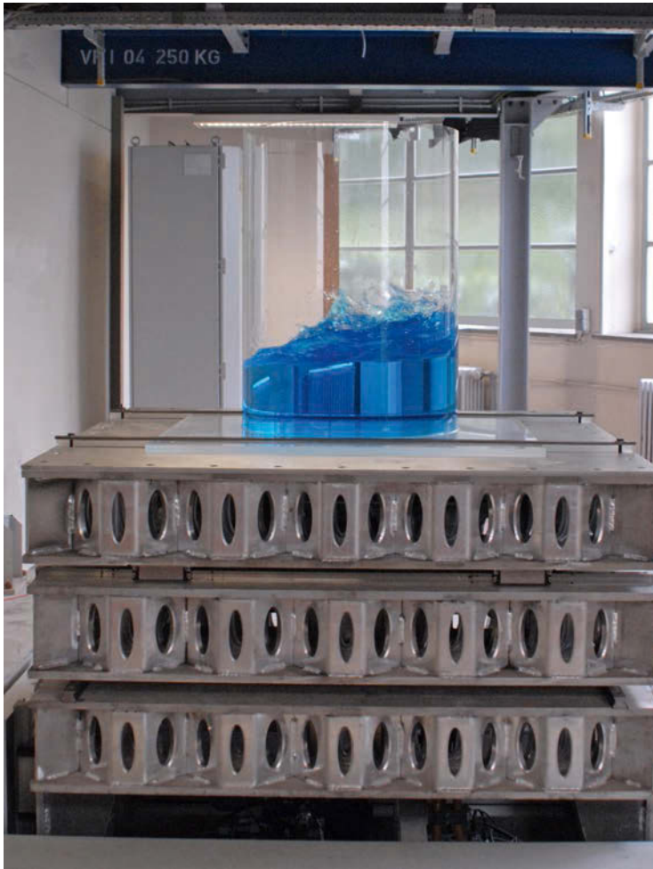
Figuur 3 – triltafel SHAKESPEARE
