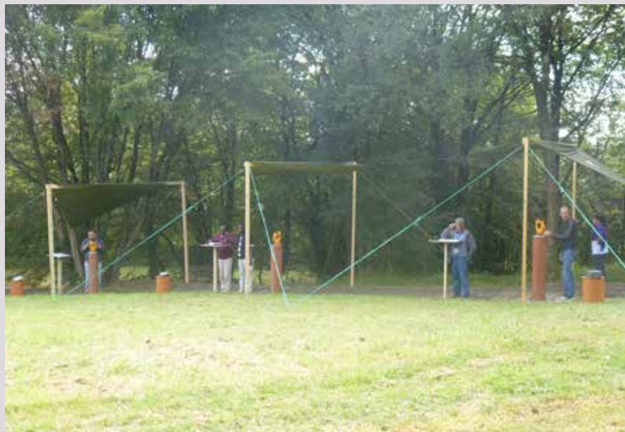
Foto van de vergelijkende ijkingscampagne van absolute metingen: drie teams meten de inclinatie en de declinatie van het aardmagnetisch veld.
