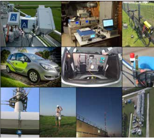
Figuur 7: Mozaïek van verschillende instrumenten die zijn ingezet tijdens CINDI-2. V.l.n.r., b.n.o.: BIRA MAX-DOAS, set van in situ analysators (NO 2 , SO 2 , O 3 , etc.), BIRA BikeDOAS, BIRA Aeromobil, BIRA NO 2 -sensor, KNMI NO 2 -radiosonde, RIVM mobiele LIDAR.
