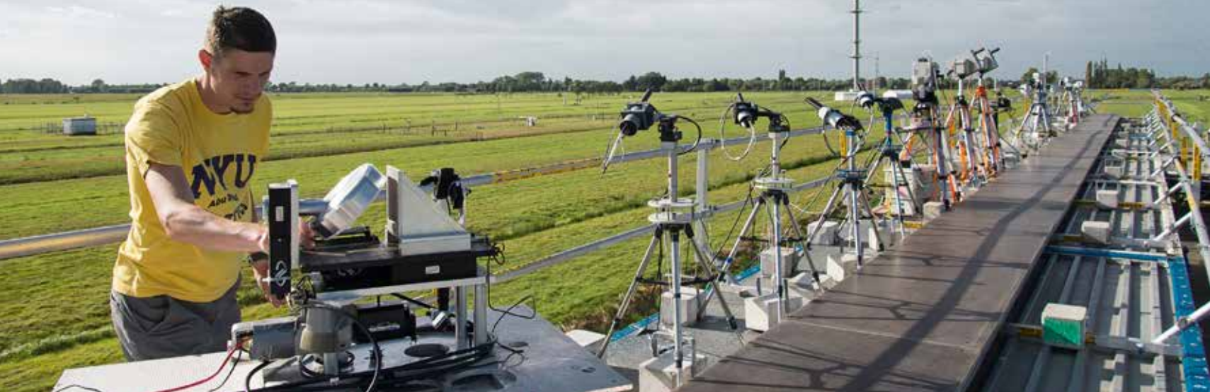
Figuur 1: (MAX-)DOAS-instrumenten naast elkaar opgesteld op het dak van het tijdelijke containerdorp.
