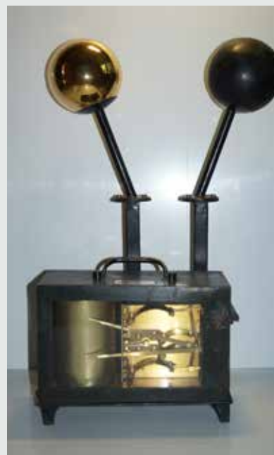
Actinomètre enregistreur, milieu du XIX e siècle, Jules Richard, Paris, Institut Royal Météorologique
