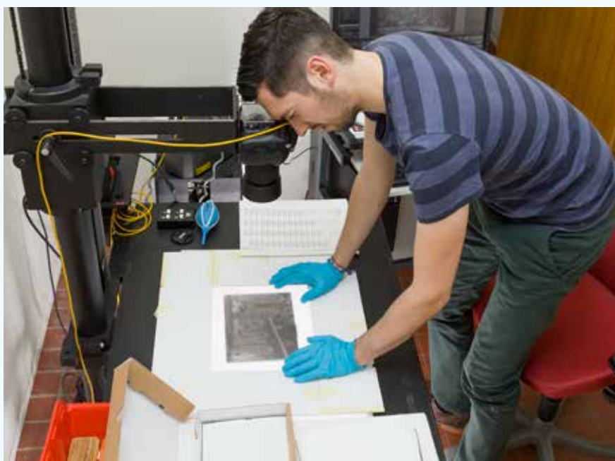
Fig. 1: Digitalisatie van een Duits negatief door middel van hogeresolutiefotografie op een lichtbak. © KIK-IRPA, Brussel, foto Katrien Van Acker, 8 maart 2016, X092619.
