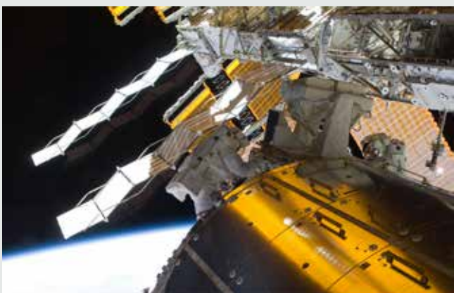
Het SOLAR-platform zit bevestigd aan de buitenkant van de Europese Columbusmodule van het Internationaal Ruimtestation (ISS).
