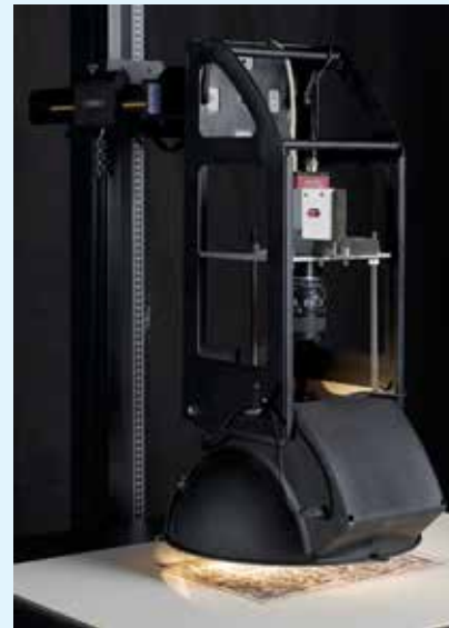
De Microdome voor 2D+ opnames. © Project Fingerprint (Digitaal Labo - KU Leuven)
