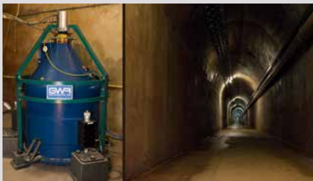
Figure 2 : Le gravimètre à supraconductivité de Membach se trouve au bout d'une galerie de 130 m, à 48 m sous la surface. La station fut construite au début des années 1970 pour l'Observatoire entre les barrages de la Gileppe et d'Eupen; elle est composée de deux chambres auxquelles on accède par une galerie. L'ensemble a été creusé dans la roche sous le plateau des Hautes-Fagnes. Photo : E. Coveliers.
