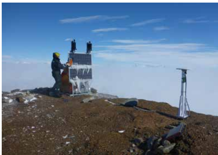
Figure 7 : Installation d'une station de positionnement par satellite (GPS, Galileo...) à 60 km au nord de la base polaire Princesse Elisabeth (Antarctique). L'un des principaux objectifs de l'acquisition de ces données est l'étude du mouvement de la croûte terrestre en réponse aux variations actuelles de masse de glace dans cette région. Photos : ORB
