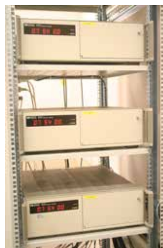
Figure 3 : L'observatoire dispose actuellement de trois horloges commerciales à jet de césium, fonctionnant sur un principe semblable à celui des premières horloges atomiques.
