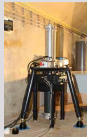
Figure 3 : Le gravimètre absolu en mesure à Membach : une masse est lâchée en chute libre dans la chambre de chute (cylindre en aluminium) où règne le vide. Photo : K. Vanneste.
