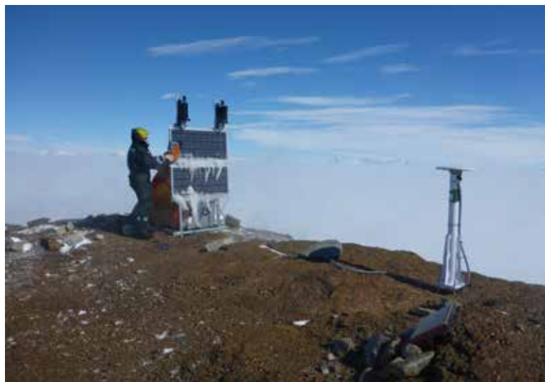
Figuur 7 : installatie van een station voor de positiebepaling aan de hand van satellieten (GPS, Galileo...) 60 km ten noorden van de poolbasis Prinses Elisabeth (Antarctica). Een van de hoofddoelen van de verzameling van deze gegevens is de studie van de beweging van de aardkorst ten gevolge van de actuele veranderingen van de ijsmassa in deze regio. Foto : KSB
