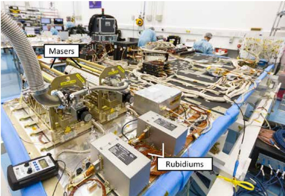
Figuur 4 : Zicht op de binnenkant van een Galileo-satelliet waarbij de atoomklokken duidelijk te zien zijn. Bron : ESA
