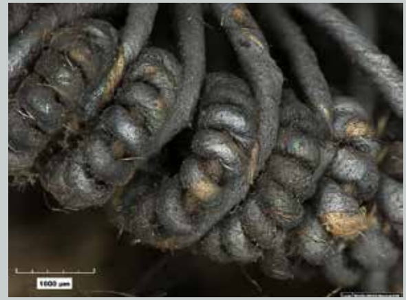
Afb. 7: Detailopname met digitale 3D-microscoop van een bloemhart (detail van afb. 4) in zilver rond een textielvezel. Het zilver is gecorrodeerd door de inwerking van polluenten.
