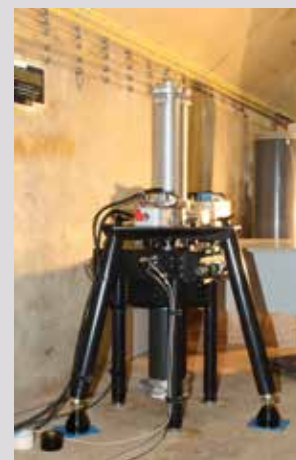
Figuur 3: De absolute gravimeter die in Membach gebruikt wordt: er wordt een massa losgelaten in vrije val in de valkamer (buis in aluminium) waarin een vacuüm heerst. Foto: K. Vanneste.
