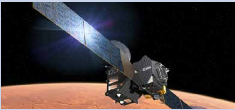
Aan boord van de satelliet ExoMars Trace Gas Orbiter bevindt zich het NOMAD-instrument van het BIRA, een state-of-the-art spectrometer die de samenstelling van de Marsatmosfeer in kaart wil brengen.
