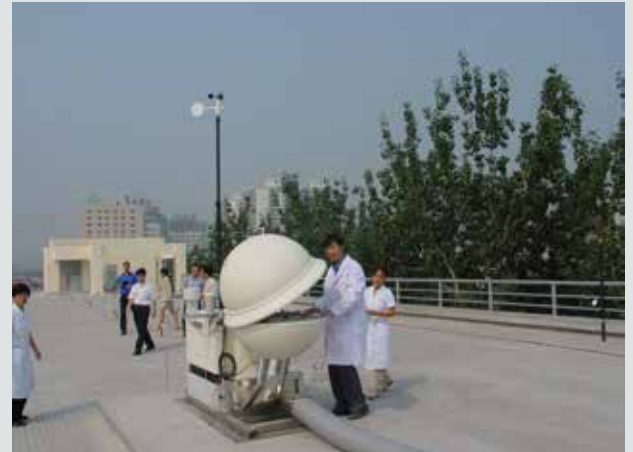
Station de mesure de particules radioactives installée à Beijing (Chine). © CTBTO Preparatory Commission
