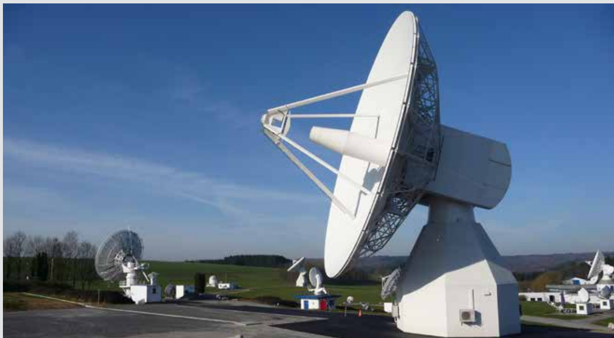
Cette antenne est utilisée pour tester les satellites Galileo. © ESA/C. Lezy, CC BY-SA 3.0 IGO
