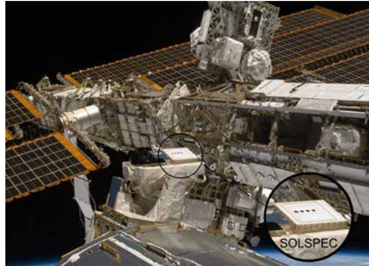
De nuttige lading SOLAR bevestigd aan de buitenkant van de Columbusmodule van het ISS.
