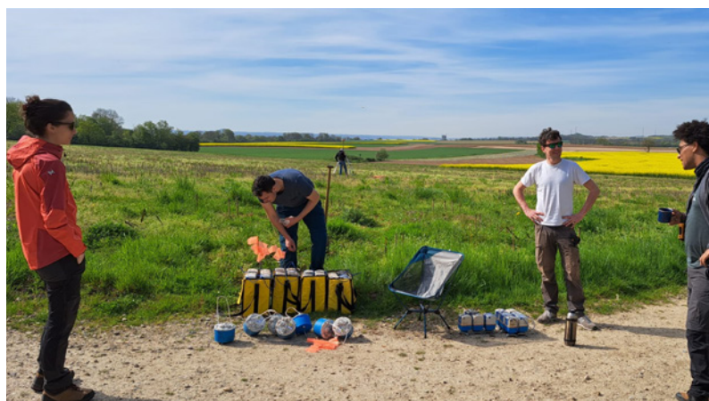
Études sismologiques sur le terrain à proximité des stations sismiques permanentes à l'aide de minions (capteurs sismiques mobiles).
