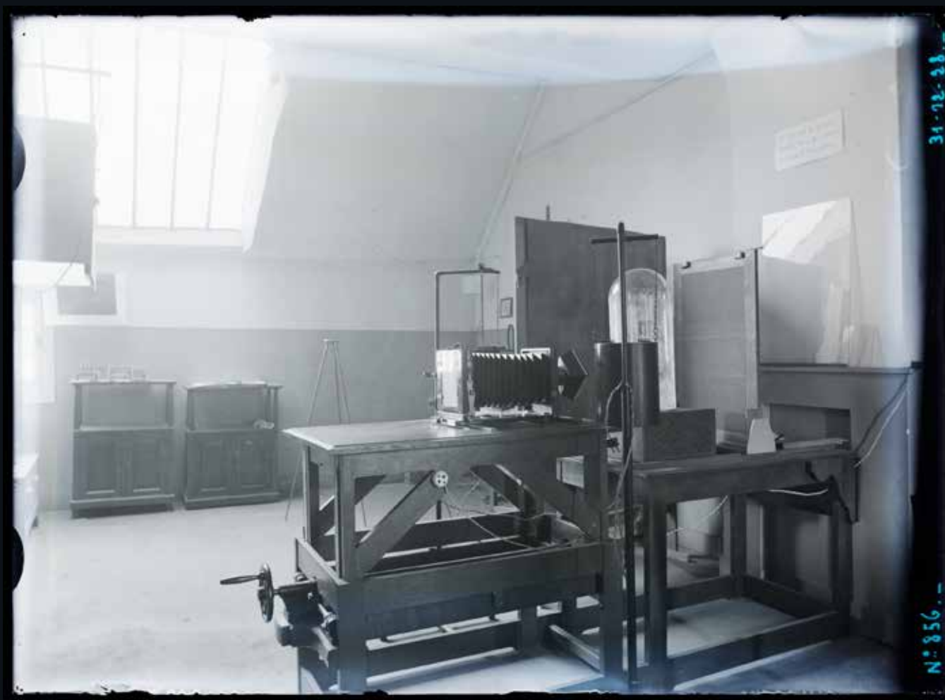
Apparatuur en procedé gebruikt door een laboratorium van de Technische en Wetenschappelijke Politie (TWP) om foto's te maken van vingerafdrukken op een glazen voorwerp, 31 december 1928. (RA Luik, Gerechtelijke Politie van Luik, archief van de Technische en Wetenschappelijke Politie)
