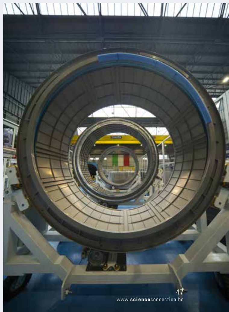
De I-Hab-module van de Gateway in aanbouw in Turijn © ESA-S. Corvaja
