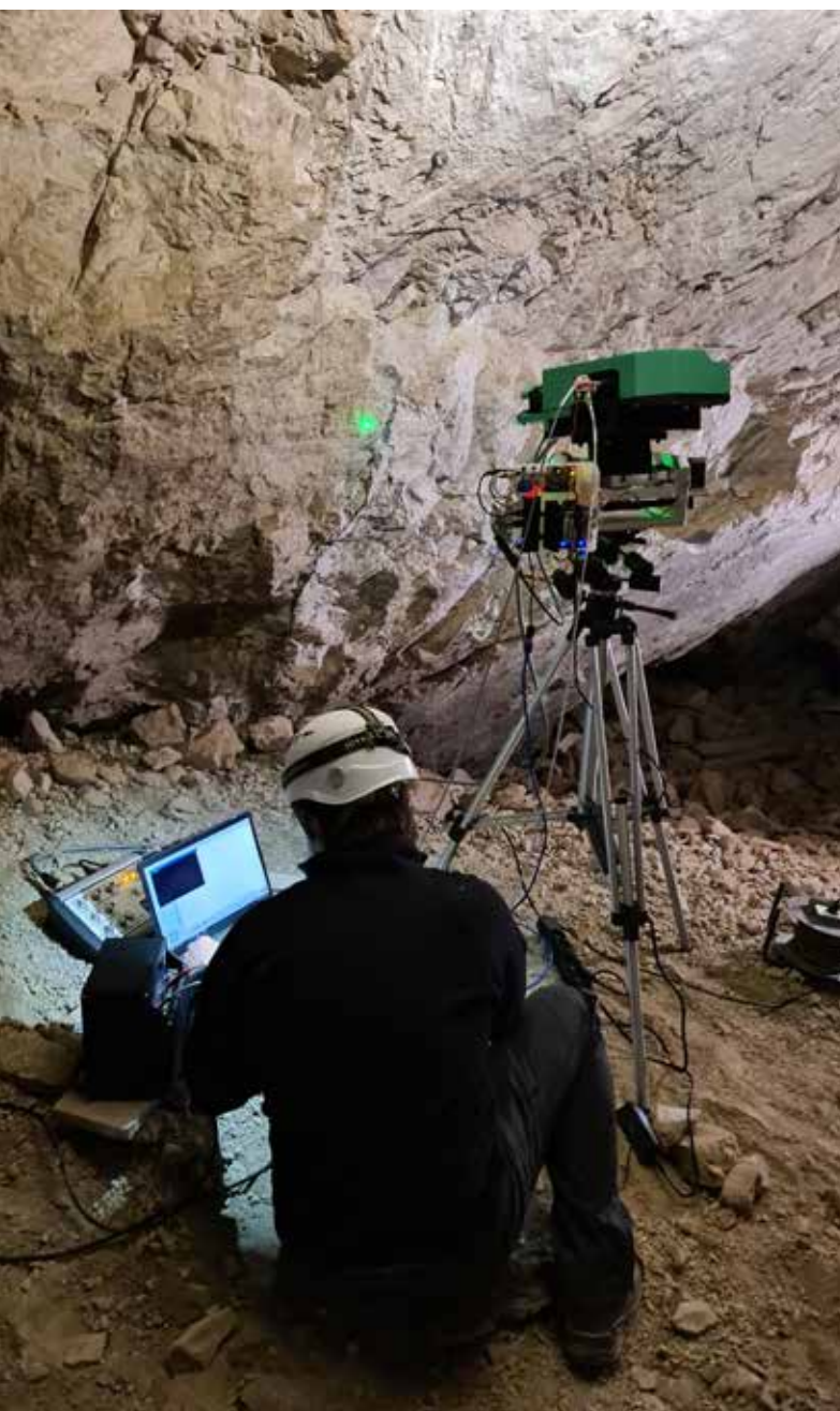
Christian Burlet bestuurt de LIBS-sensor. Door de rotswand punt per punt, lijn per lijn te scannen, krijgen zowel de onderzoekers als de robot een gedetailleerd beeld van het oppervlak. © Siska Van Parys, Instituut voor Natuurwetenschappen
