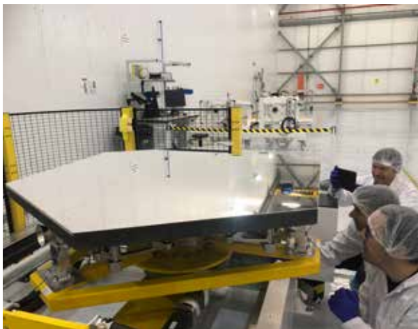
Het oppervlak van de segmenten van de spiegels van de ELT (links) wordt geregeld vernieuwd dankzij het door AGC Glass Europe ontwikkelde instrument (rechts). (Foto's Sophie Pireaux)
