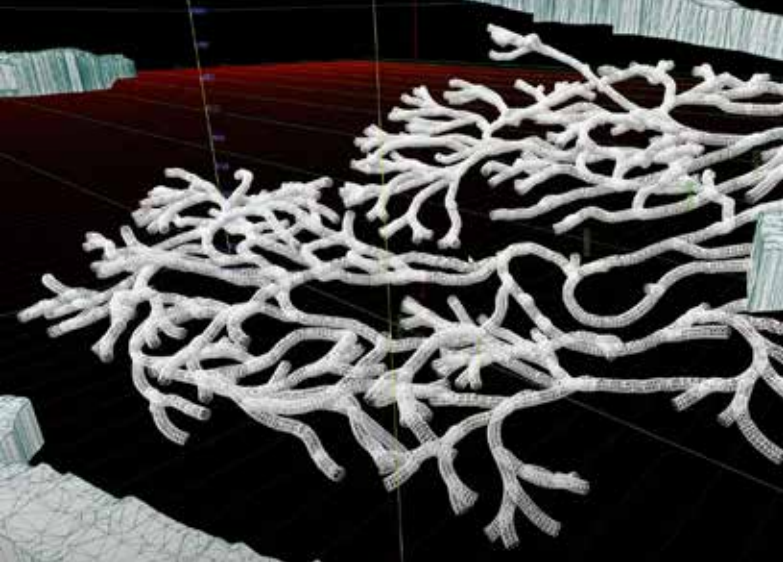
Een simulatie van de gangen die de robot zou graven als hij beslissingen neemt volgens het Greedy-algoritme. © Milan Milanov, 4Dcoders
