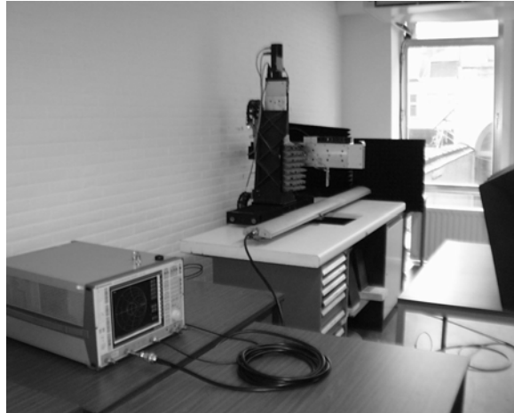
Figuur 5: Foto van de opstelling voor het in-lab opmeten van elektromagnetische velden.
