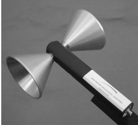
Figuur 10: Conische dipoolantenne PCD 8250 van het Oostenrijkse Onderzoekscentrum in Seibersdorf.
