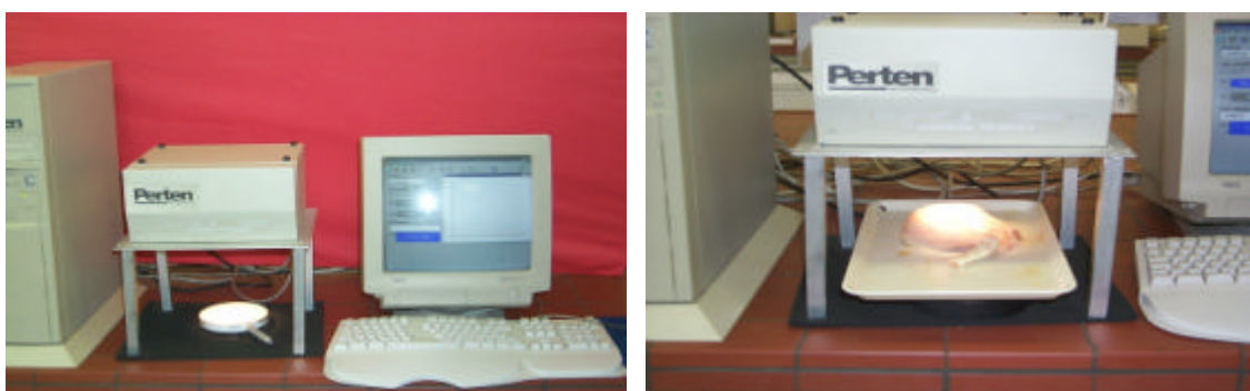
Photos 6 et 7 : Appareil DA 7000 Perten lors de l'analyse d'une cuisse de poulet.
