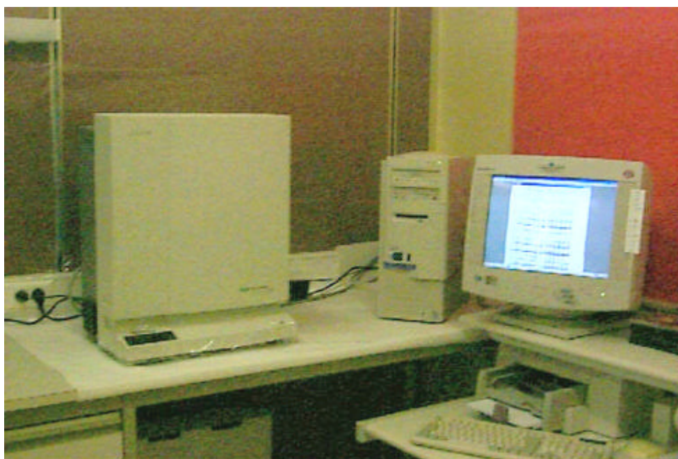
Photo 3 : Séquenceur automatique GENE READIR™ DNA ANALYSIS SYSTEM L4200S-1 utilisé pour l'analyse d'empreintes génétiques de poulet.
