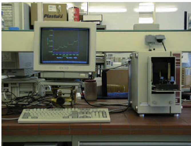
Photo 8: Appareil NIRSystems 5000 en configuration Spinning utilisé lors de l'analyse d'échantillons d'aliments pour bétail
