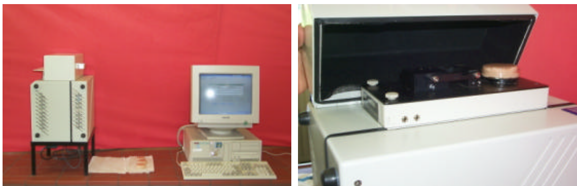
Photos 4 et 5 : Appareil NIRSystems 6500 en configuration DCA (Direct Contact Analysis) utilisé pour l'analyse d'échantillons de viande de poulet.
