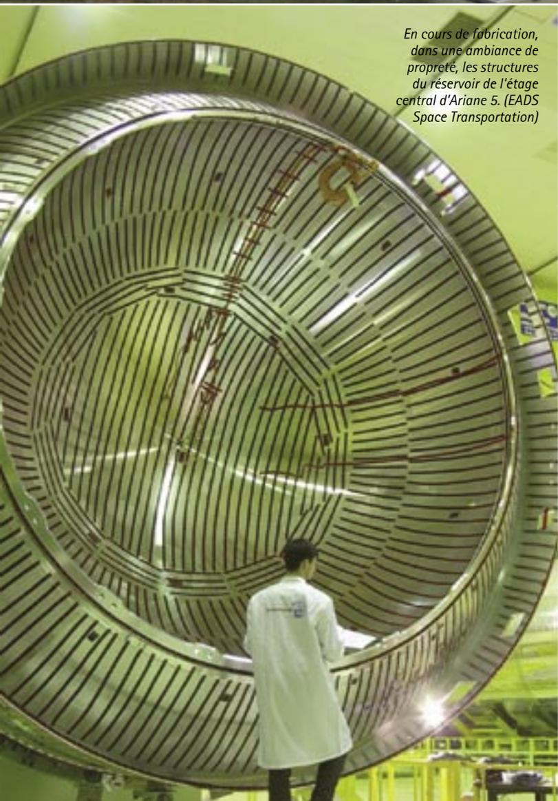
*En cours de fabrication, dans une ambiance de propreté, les structures du réservoir de l'étage central d'Ariane 5. (EADS Space Transportation)*
