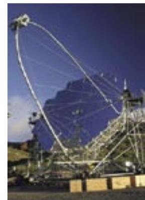
miroir présente un diamètre de 17 m et une superficie de 236 m<sup>2</sup>. La grande quantité de rayons gamma captés nous donne des informations sur les événements intervenant dans l'espace. L'analyse des données reçues par le télescope MAGIC et la génération de simulations de gerbes atmosphériques de rayons cosmiques sont réalisées par l'intermédiaire de l'infrastructure en grille européenne.
