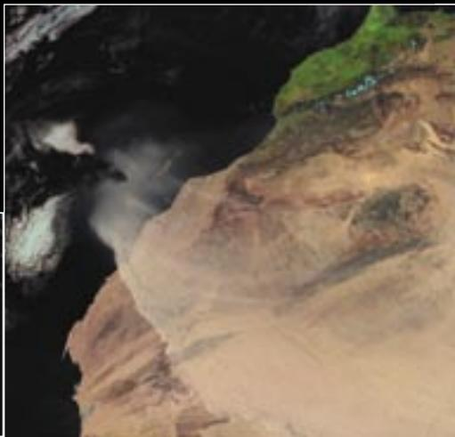
Les chercheurs du Imperial College de Londres utilisent les données de GERB pour quantifier le forçage radiatif dû aux aérosols, comme par exemple au début Mars 2004 lorsqu'un nuage de poussière arraché du Sahara par le vent se répand sur des milliers de kilomètres au dessus de l'atlantique. Les images montrent le détecteur du nuage de sable sur base du canal SEVIRI à 0.6µm et le flux solaire GERB. (© IRM)
