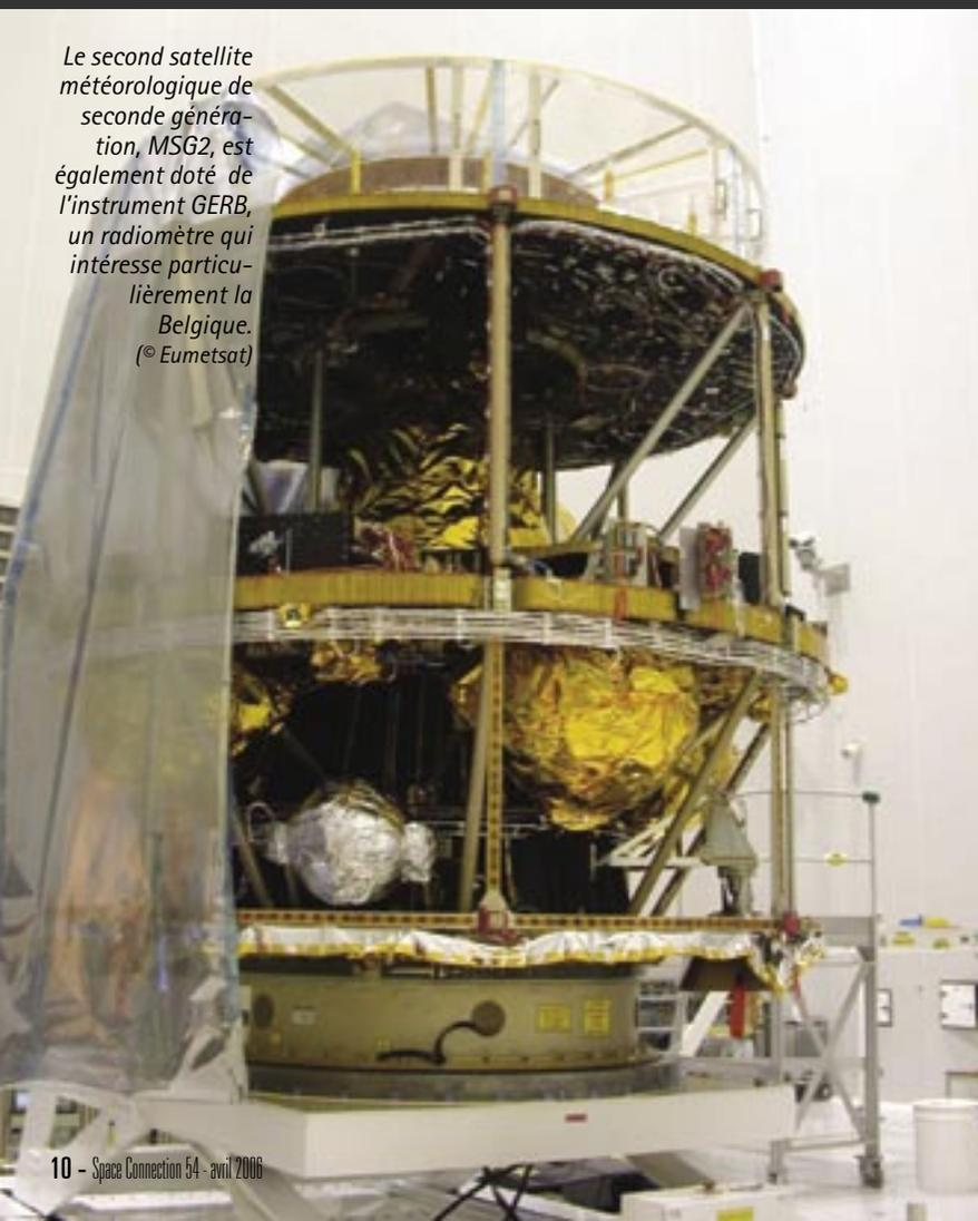
Le premier instrument GERB a été lancé en orbite avec le satellite MSG-1. Le second radiomètre GERB vient de prendre le chemin de l'orbite géostationnaire avec MSG-2, en décembre dernier. Deux autres copies de cet instrument équiperont encore les prochains Météosat de nouvelle génération. De quoi assurer pendant 15 ans une surveillance ininterrompue du bilan radiatif de la Terre.
